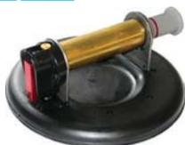
Adatte per trasportare lastre con superfici lisce e piane. Robusta costruzione rivestita in gomma, corpo pompa in ottone e pistone in materiale sintetico. Il vuoto è ottenuto mediante l'azionamento della pompa manuale e può essere controllato sul pistone grazie ad un indicatore di colore rosso.
