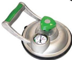
Adatte per trasportare lastre con superfici lisce come il vetro, plastica, metalli ecc. Costruzione in fusione d'alluminio. Con vuotometro per il riscontro della pressione di presa. Con manopola centrale per la regolazione del vuoto.
